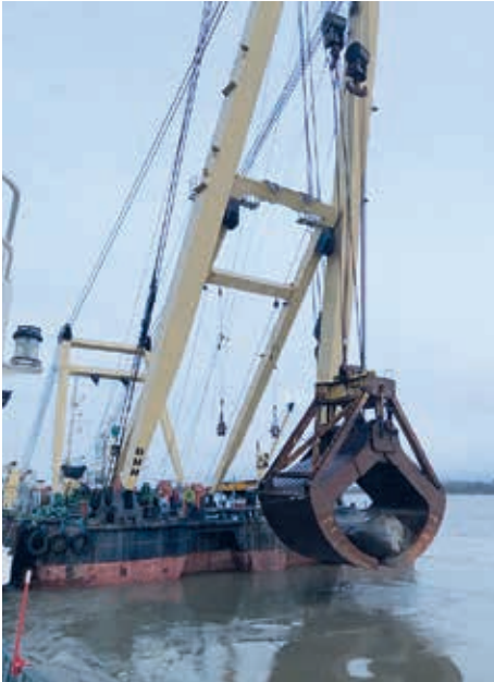
Schwimmkran ENAK mit dem im Wasser geborgenen Findling (Foto: Lühns Schifffahrts-GmbH & Co)
